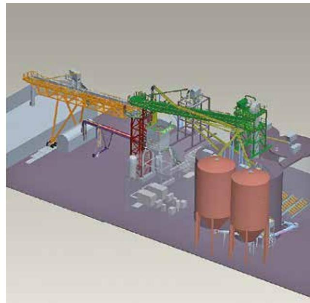
**Cement los- en laadinstallatie 500T/H**
